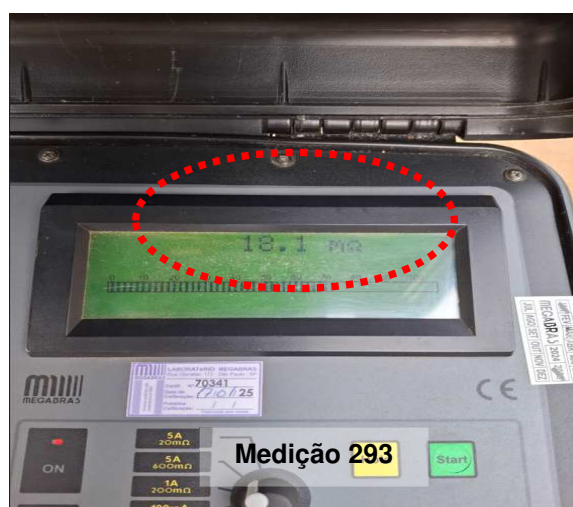
Figuras 193 e 194: Ponto 297/ Medição 293 -Ponto aterramento estrutura metálica – PTAR.
