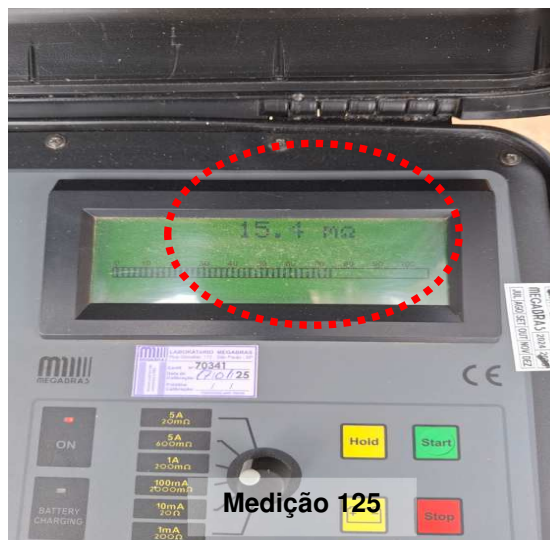
Figuras 91 e 92: Ponto 126 /Medição 125 - Ponto aterramento pilar metálico Pipe rack.
