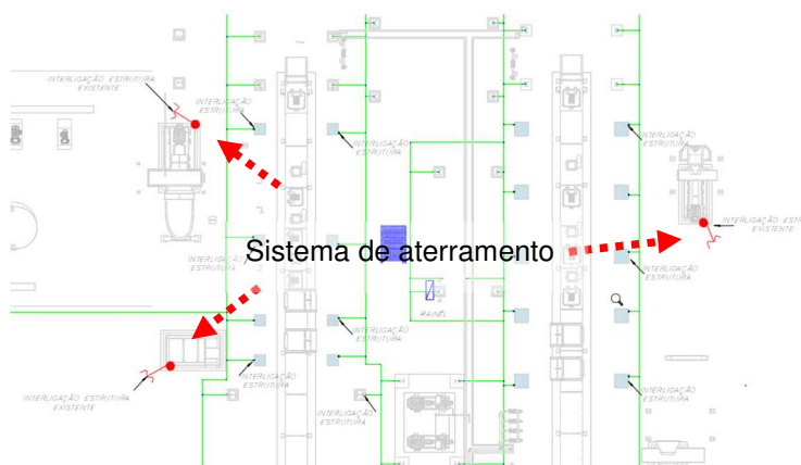
Figura 293: Sistema aterramento encontrado não constantes em planta //Pontos em vermelho.
