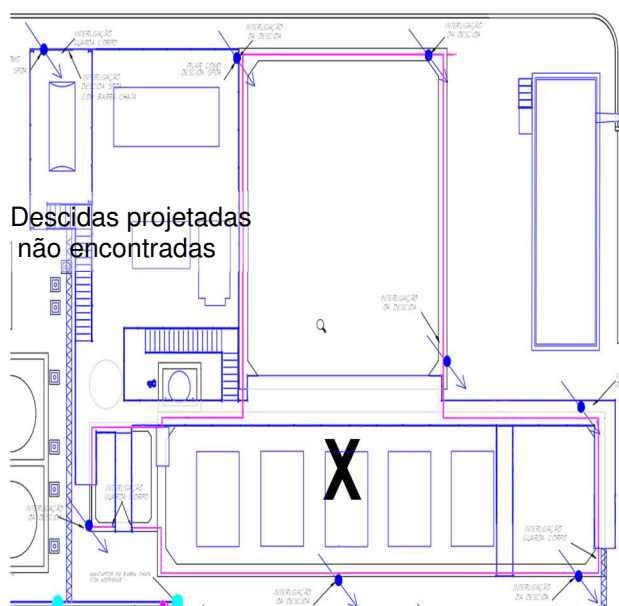
Figuras 196 e 197: Malha captora em rosa (adequar) ao arranjo existente. Descidas do SPDA não encontradas //Área encontrada na inspeção visual.
