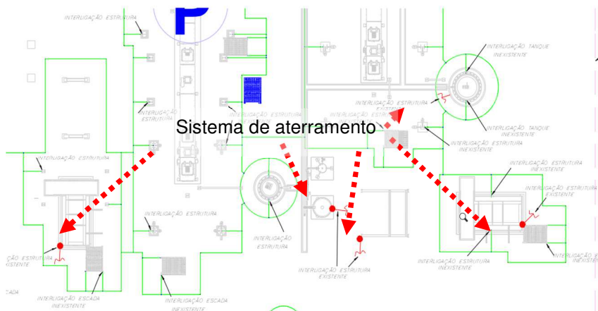
Figura 292: Sistema aterramento encontrado não constantes em planta //Pontos em vermelho.
