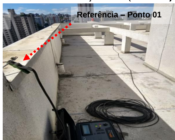
Figuras 07 e 08: Referência Ponto 01 – Descida nº 04 A do SPDA na cobertura - (Torre 01).
