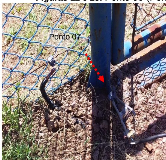
Figuras 14 e 15: Ponto 07- Ponto aterramento de estrutura (Pilar gás) - Medição 06.
