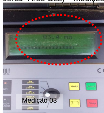
Figuras 08 e 09: Ponto 04 (Ponto aterramento cerca- Área Gás) – Medição 03
