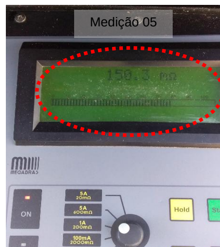
Figuras 12 e 13: Ponto 06-(Ponto aterramento cerca- Área Gás) - Medição 05.
