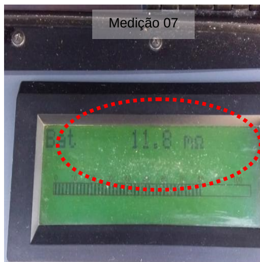
Figuras 16 e 17: Ponto 08- (Ponto aterramento cerca- Área Gás) - Medição 07.
