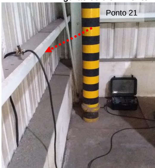
Figuras 38 e 39: Ponto 21- Aterramento/Estoque de Produção (Descida SPDA) - Medição 18.
