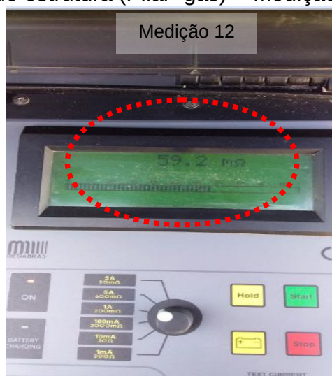
Figuras 26 e 27: Ponto 13- Ponto aterramento de estrutura (Pilar gás) - Medição 12.
