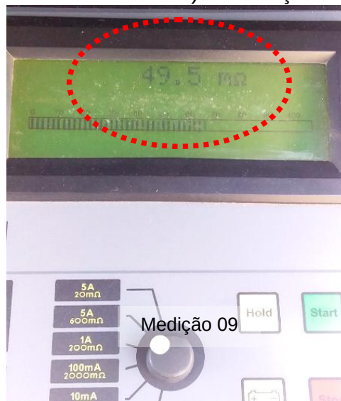
Figuras 20 e 21: Ponto 10-(Ponto aterramento cerca- Área Gás) - Medição 09.
