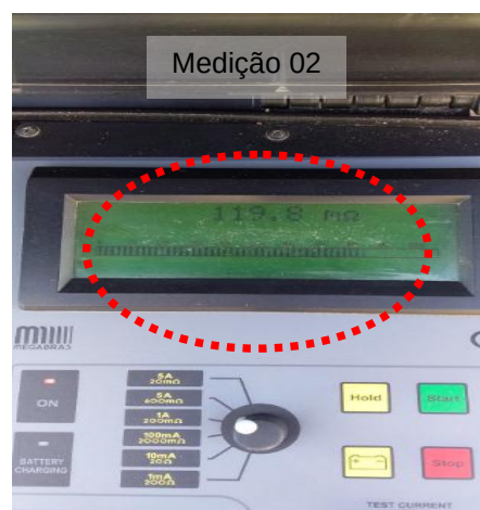
Figuras 06 e 07: Ponto 03 (Ponto aterramento cerca- Área Gás) – Medição 02
