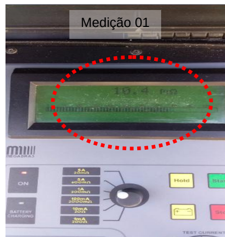
Figuras 04 e 05: Ponto 01 (BEP) - Medição 01 - Ponto aterramento de estrutura (Pilar gás)
