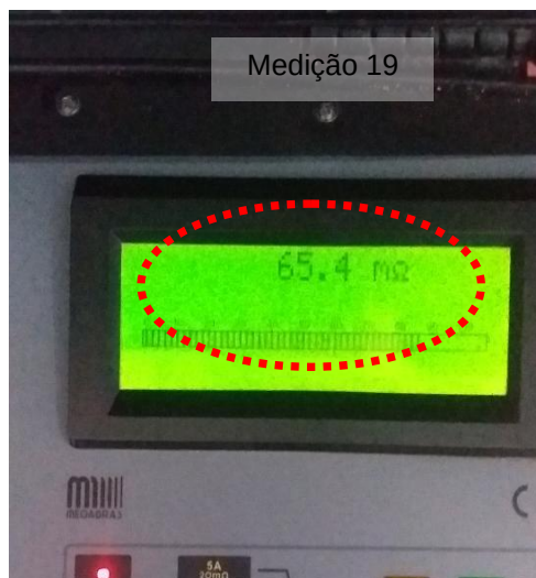
Figuras 40 e 41: Ponto 23- Atterramento Pilar/Estoque de Produção (Descida SPDA) - Medição 19.
