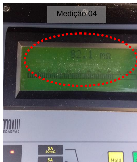
Figuras 10 e 11: Ponto 05- (Ponto aterramento cerca- Área Gás) - Medição 04.
