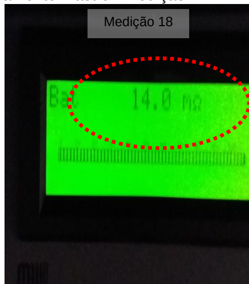
Figuras 38 e 39: Ponto 21- Aterramento/Estoque de Produção (Descida SPDA) - Medição 18.
