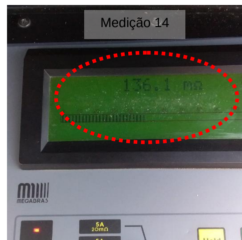
Figuras 30 e 31: Ponto 16- Aterramento pilar/Estoque de Produção (Descida SPDA) - Medição 14.
