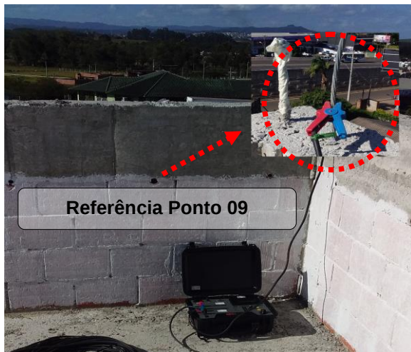
Figuras 07 e 08: Ponto BEP B – Ponto 09 referência descida SPDA, conforme planta de captação DE-9782-002, Medição 01.
