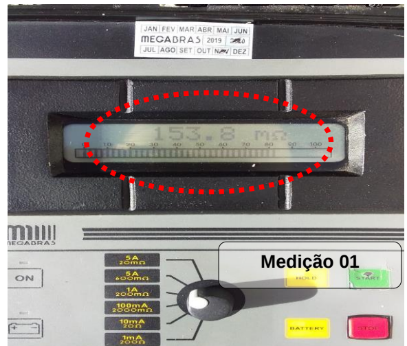
Figuras 07 e 08: Ponto BEP B – Ponto 09 referência descida SPDA, conforme planta de captação DE-9782-002, Medição 01.
