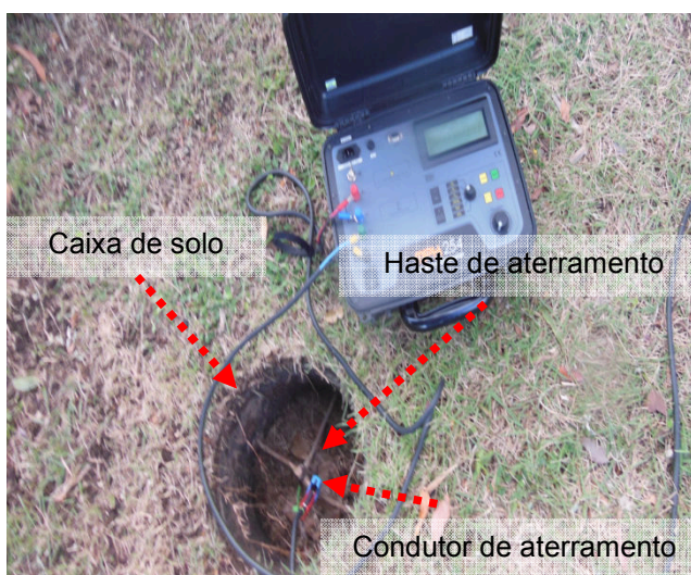
Figuras 71 e 72: Sistema Aterramento – Portaria 02 – Caixa de solo/ Interligação da malha de aterramento c/ elementos metálicos
