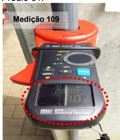
Figuras 848 e 849: Medição do ensaio realizado no ponto 109 – Descida do SPDA – Engarrafamento/Estoque – Prédio 01.
