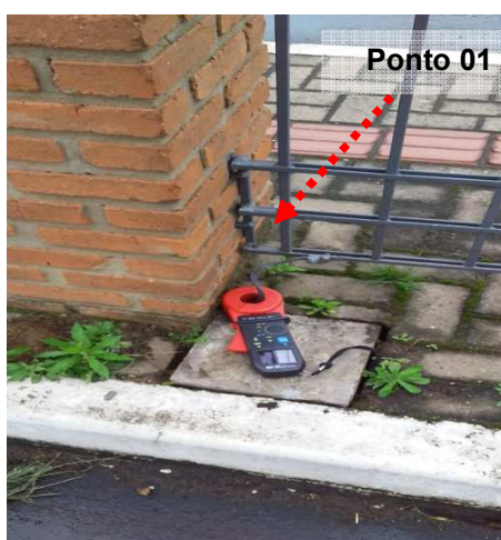
Figuras 674 e 675: Medição do ensaio realizado no ponto 01 – Condutor Cabo de Cobre #50mm 2 – Fábrica da Felicidade – Prédio 19
