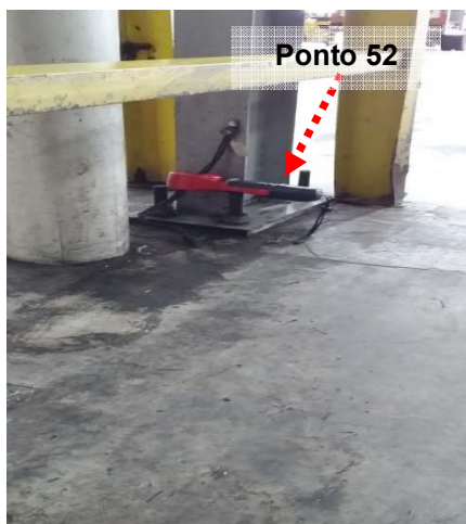
Figuras 744 e 745: Medição do ensaio realizado no ponto 52 – Descida do SPDA – Operações Logísticas – Prédio 31D.
