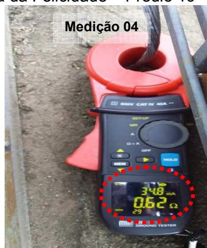
Figuras 680 e 681: Medição do ensaio realizado no ponto 04 – Condutor Cabo de Cobre #50mm 2 – Fábrica da Felicidade – Prédio 19
