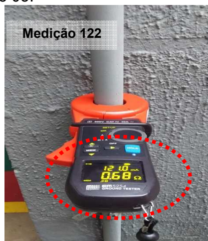
Figuras 874 e 875: Medição do ensaio realizado no ponto 122 – Descida do SPDA – Silo e Açúcar – Prédio 03.
