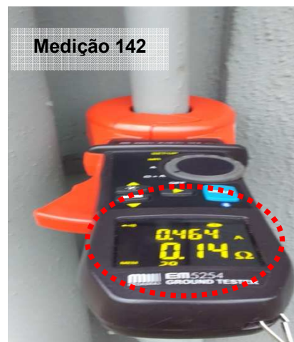
Figuras 900 e 901: Medição do ensaio realizado no ponto 142 – Descida do SPDA – Utilidades – Prédio 28.
