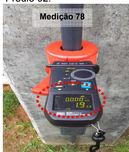
Figuras 796 e 797: Medição do ensaio realizado no ponto 78 – Descida do SPDA – Depósito de Latas e Sopro – Prédio 02.
