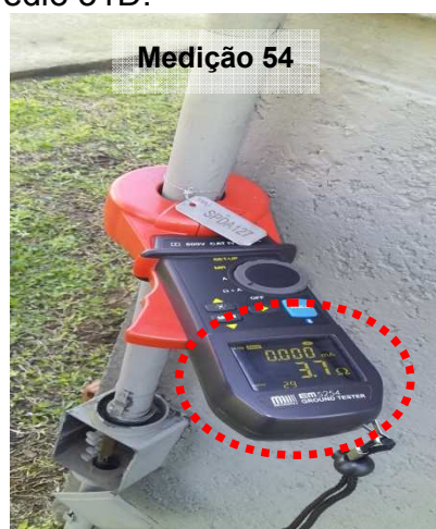
Figuras 748 e 749: Medição do ensaio realizado no ponto 54 – Descida do SPDA – Manutenção da Frota – Prédio 07.
