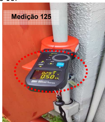
Figuras 878 e 879: Medição do ensaio realizado no ponto 125 – Descida do SPDA – Silo e Açúcar – Prédio 03.
