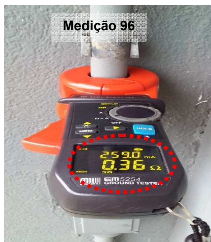
Figuras 822 e 823: Medição do ensaio realizado no ponto 96 – Descida do SPDA – Engarrafamento/Estoque – Prédio 01.
