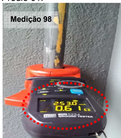
Figuras 826 e 827: Medição do ensaio realizado no ponto 98 – Descida do SPDA – Engarrafamento/Estoque – Prédio 01.
