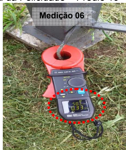
Figuras 682 e 683: Medição do ensaio realizado no ponto 06 – Condutor Cabo de Cobre #50mm 2 – Fábrica da Felicidade – Prédio 19
