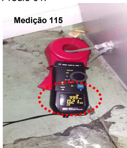
Figuras 860 e 861: Medição do ensaio realizado no ponto 115 – Descida do SPDA – Engarraamento/Estoque – Prédio 01.
