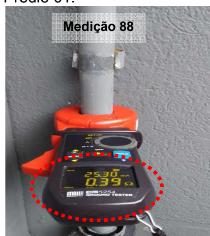
Figuras 812 e 813: Medição do ensaio realizado no ponto 88 – Descida do SPDA – Engarrafamento/Estoque – Prédio 01.
