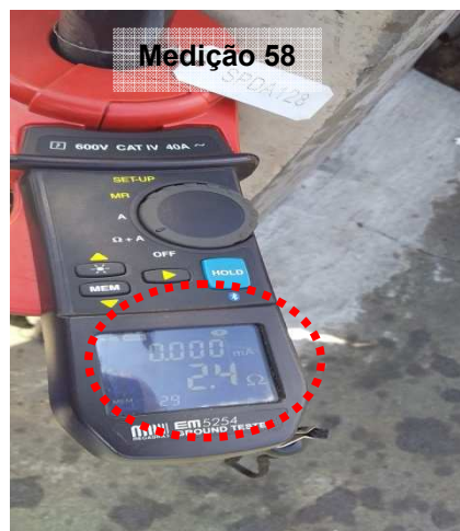
Figuras 756 e 757: Medição do ensaio realizado no ponto 58 – Descida do SPDA – Manutenção da Frota – Prédio 07.
