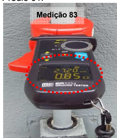
Figuras 806 e 807: Medição do ensaio realizado no ponto 83 – Descida do SPDA – Engarrafamento/Estoque – Prédio 01.
