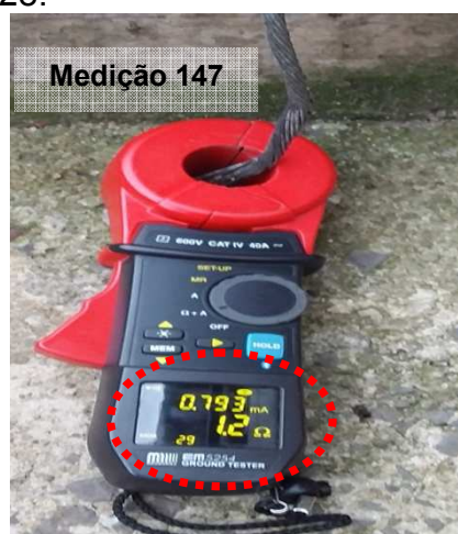
Figuras 910 e 911: Medição do ensaio realizado no ponto 147 – Estrutura metálica Motor – Utilidades – Prédio 28.
