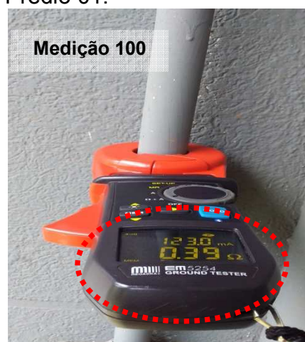
Figuras 830 e 831: Medição do ensaio realizado no ponto 100 – Descida do SPDA – Engarrafamento/Estoque – Prédio 01.
