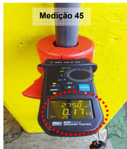
Figuras 738 e 739: Medição do ensaio realizado no ponto 45 – Descida do SPDA - Almoxarifado – Prédio 06.
