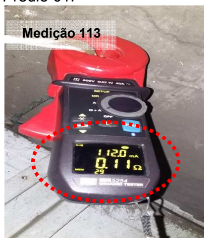
Figuras 856 e 857: Medição do ensaio realizado no ponto 113 – Descida do SPDA – Engarrafamento/Estoque – Prédio 01.
