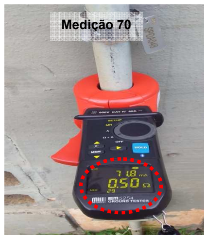
Figuras 780 e 781: Medição do ensaio realizado no ponto 70 – Descida do SPDA – Depósito de Latas e Sopro – Prédio 02.
