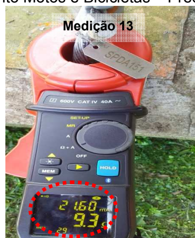
Figuras 694 e 695: Medição do ensaio realizado no ponto 13 – Condutor Cabo de Cobre #50mm 2 – Estacionamento Motos e Bicicletas – Prédio 17
