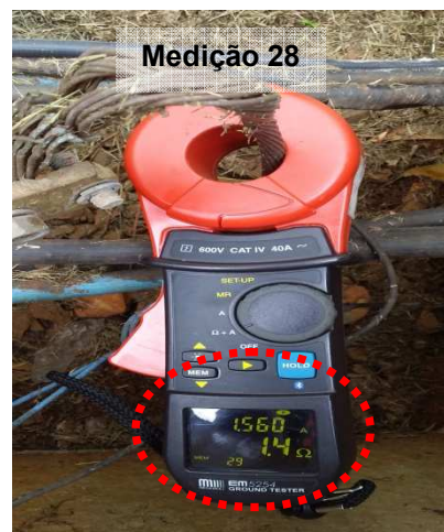
Figuras 708 e 709: Medição do ensaio realizado no ponto 28 – Caixa de Inspeção de Solo - Operações Logísticas – Prédio 31A
