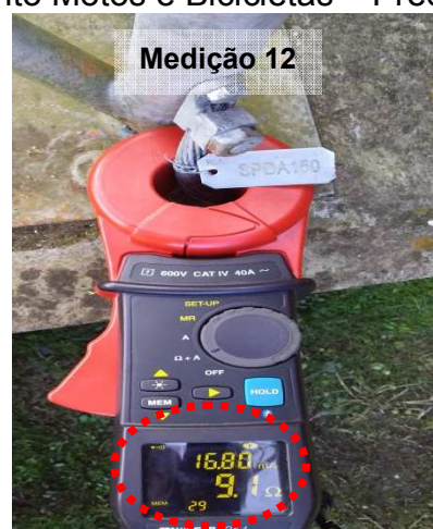
Figuras 692 e 693: Medição do ensaio realizado no ponto 12 – Condutor Cabo de Cobre #50mm 2 – Estacionamento Motos e Bicicletas – Prédio 17
