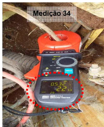
Figuras 720 e 721: Medição do ensaio realizado no ponto 34 – Caixa de Inspeção de Solo - Operações Logísticas – Prédio 31A
