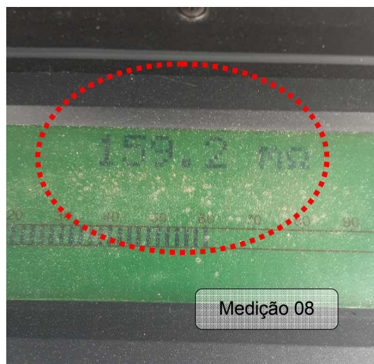
Figuras 21 e 22: Ponto 08 - Medição na cobertura – Descida 04A do SPDA.
