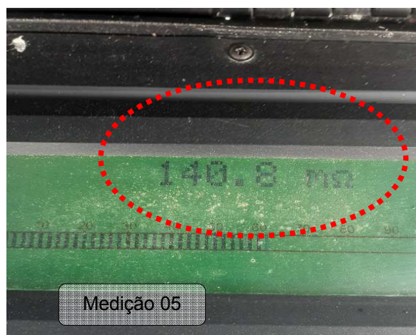
Figuras 15 e 16: Ponto 05 - Medição na cobertura – Descida 02B do SPDA
