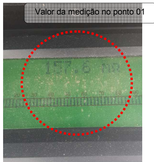
Figuras 05 e 06: Espera BEP no andar térreo - Valor da medição na descida 01 do SPDA - Pilar nº 30 na cobertura da edificação.
