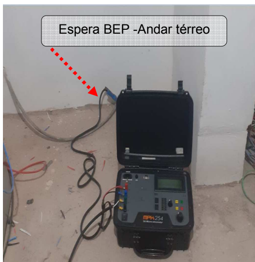
Figuras 05 e 06: Espera BEP no andar térreo - Valor da medição na descida 01 do SPDA - Pilar nº 30 na cobertura da edificação.
