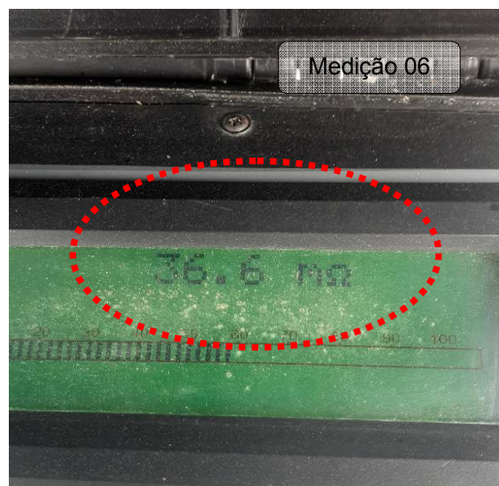
Figuras 17 e 18: Ponto 06 - Medição na cobertura – Descida 03B do SPDA.
