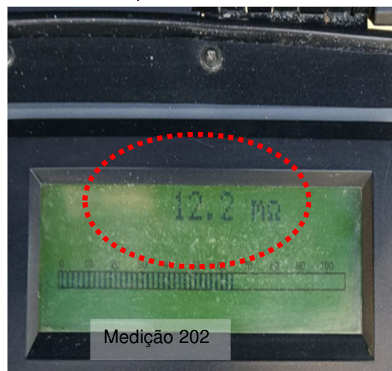
Figuras 147 e 148: Medição 202 – Aterramento estrutura pilar metálico – Chiller.
