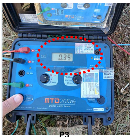
Figura 183: Valores das medições em (P3). Depósito de tintas e bombonas
